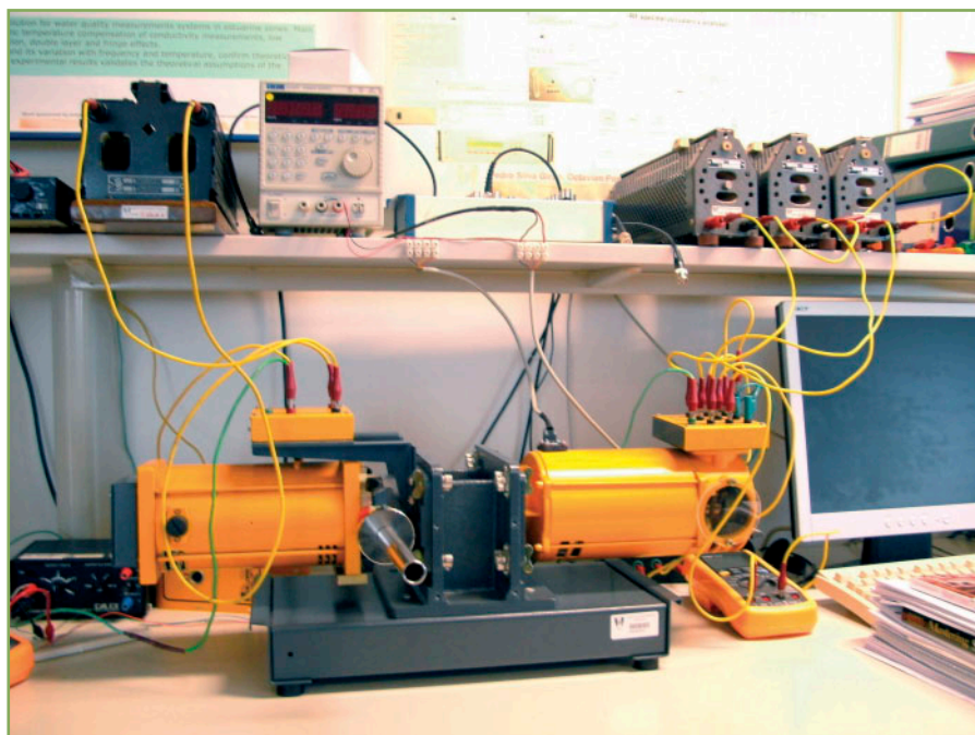
F8. Estrutura de teste montada para simulação de falhas em motores.
